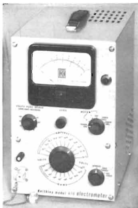
Elettrometro con alimentazione in alternata con ben 64 campi di misura per il controllo di tensioni, correnti e resistenze.
