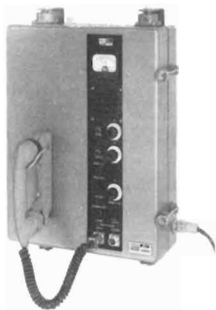
Sopra: ricetrasmittitore a camera stagna, mod. 59-5; sotto, a sinistra, il ponte ripetitore automatico, mod. 57-2, ed ancora un particolare del ricetrasmittitore a sei canali, mod. 59-1.
